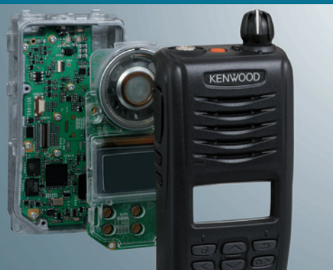
落下・衝撃に強い二重構造パネル
