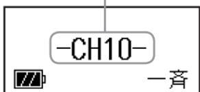
\*：ロータリースイッチをまわしている間は、呼び出し先表示からチャンネル表示に変わります。
